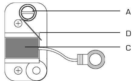
✓ Si la perceuse s'arrête sans aucune raison, vérifier les charbons. Un dispositif automatique arrête la perceuse avant que les charbons soient usés et protège le moteur.
